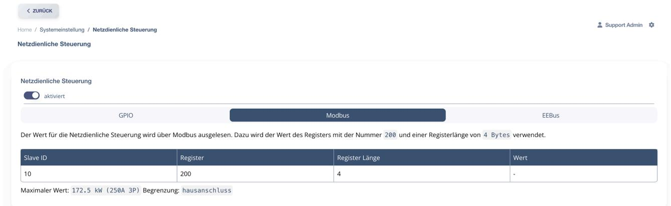
Abbildung 22: Netzdienliche Steuerung MODBUS
